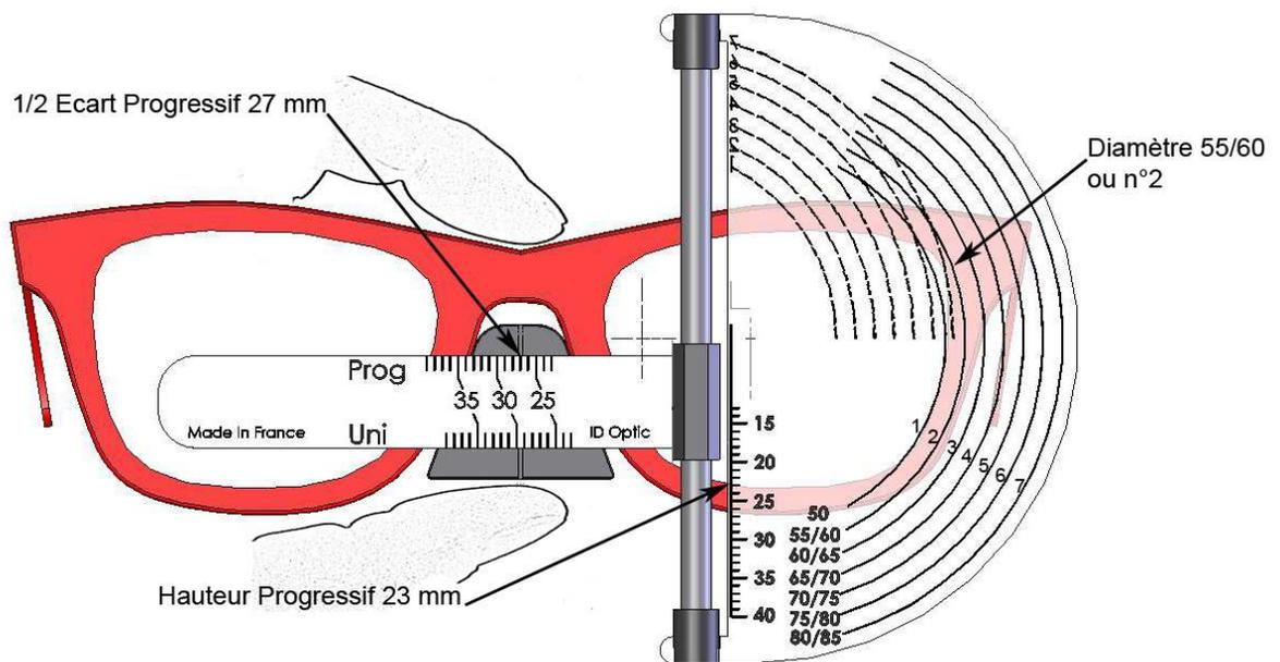
Indiquez le 1/2 écart (27mm), posez le testeur en le maintenant avec le pouce et l'index, indiquez la hauteur et relevez le diamètre utile qui est dans l'exemple **55/60** ou **n°2**.
