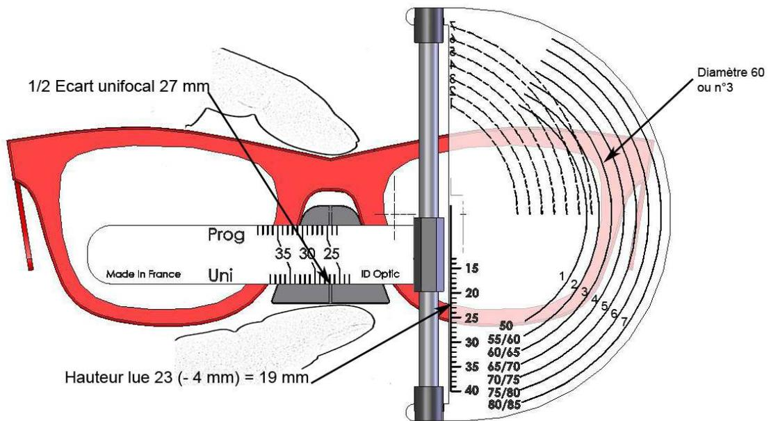
Indiquez le 1/2 écart (27mm), posez le testeur en le maintenant avec le pouce et l'index, indiquez la hauteur **en ajoutant 4mm** et relevez le diamètre utile qui est dans l'exemple **60/65** ou n°3. Comme il s'agit d'un **unifocal**, (60/65) correspond à un diamètre utile de **60mm**.
